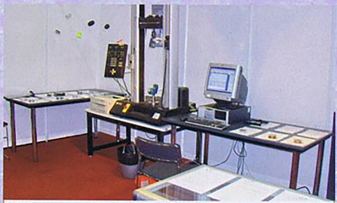
■ Laboratorio técnico para la prueba de resistencia real a la tracción, de los hilos cedidos (voluntario).
